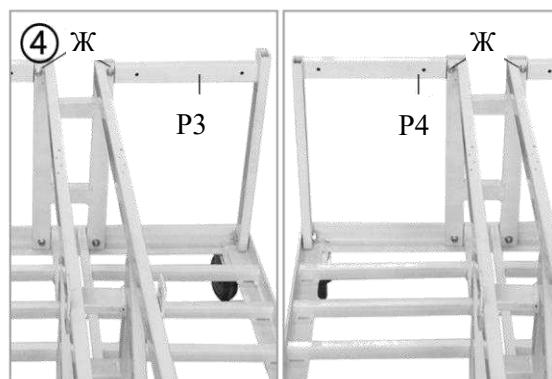
2. Подсоедините передние и задние опорные балки (P3 и P4 соответственно) к опоре (P2) и закрепите их при помощи винтов Ж, как показано на рисунке 4. Обратите внимание, что колёса на задних опорных рамках (P4) – универсальные.
