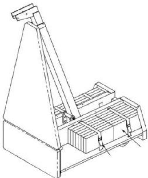
14. Для обеспечения стабильности конструкции и безопасности её использования, в опору баскетбольной стойки необходимо расположить утяжелитель весом 250 кг. Закрепите утяжелитель при помощи тросов, чтобы избежать его смещение.
