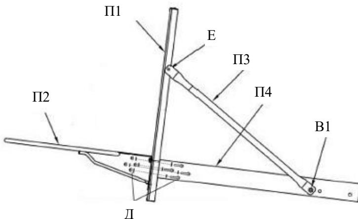
12. Соедините баскетбольную корзину (П2), щит (П1) и верхнюю опору (П4) при помощи винта (Е). Затем подсоедините опору для баскетбольного щита (П3) к самому баскетбольному щиту при помощи винта Е, а также верхнюю опору – при помощи винта В1 (как показано на рисунке наверху).
