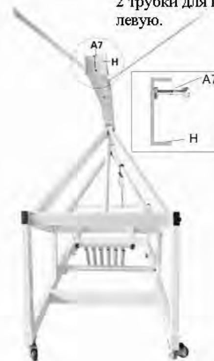
Вставьте винт (А7) в отверстие на передней части основной стойки (H) как показано, затяните винт (А7). Данный винт предназначен для регулировки щита в вертикальном положении.
