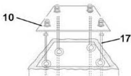
ШАГ 1Б. Зафиксируйте опорную стойку (1) на крепёжной пластине (10).
