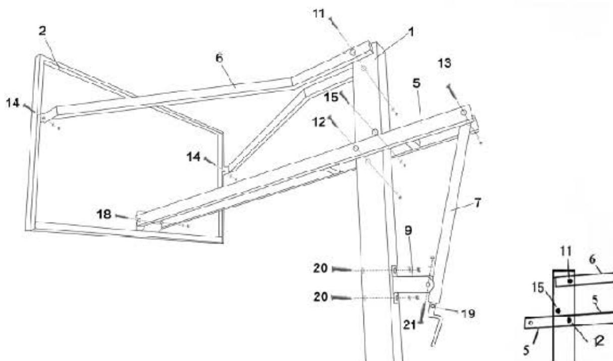
ШАГ 5. Закрепите кронштейн (9) по центру опорной стойки (1), используя болты M12x180 мм (20).
