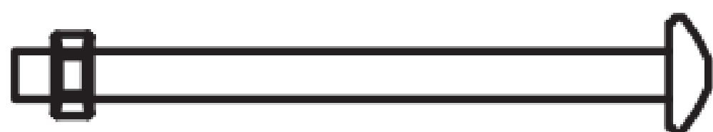
БОЛТЫ И ГАЙКИ БАТУТА
