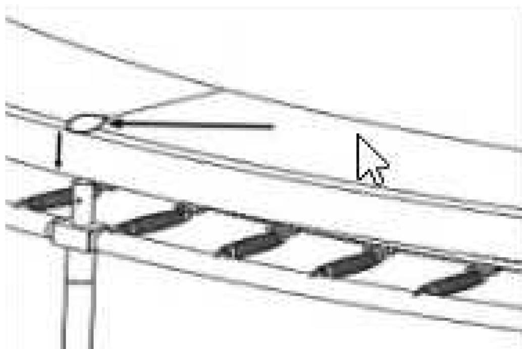
**В.** ПЛОТНО ЗАТЯНИТЕ ЭЛАСТИЧНЫЕ РЕМНИ, ЧТОБЫ ПРОКЛАДКА ЗАКРЫВАЛА РАМУ. ЗАВЯЖИТЕ УЗЕЛ, КАК ПОКАЗАНО НА РИСУНКЕ. УБЕДИТЕСЬ, ЧТО ПОДКЛАДКА РАМЫ ЗАКРЫВАЕТ ВСЕ МЕТАЛЛИЧЕСКИЕ ЧАСТИ.
