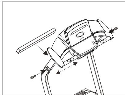
Установите фиксирующую перекладину на стойку. Не забудьте установить крышку перекладины (№8), используя болт №1 с шайбой №9 и инструмент №6.
