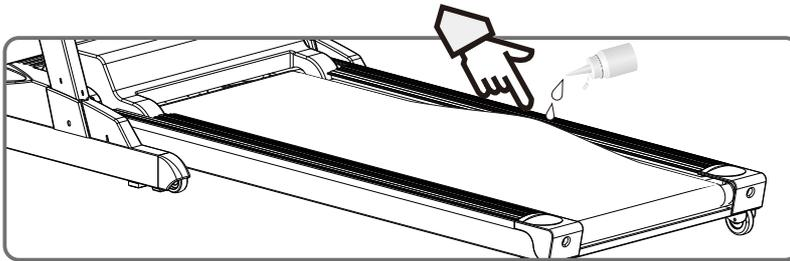
\* Для смазывания полотна оттяните беговое полотно и впрысните силикон на деку между беговым полотном и декой. По центральной части деки, равномерно. После смазки включите дорожку на 3 минуты для равномерного распределения смазки.
