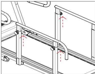
Оттяните фиксаторы поручней и отрегулируйте положение поручней вверх-вниз. Установите поручни и зафиксируйте их на необходимой высоте, закрутив фиксатор по часовой стрелке.
