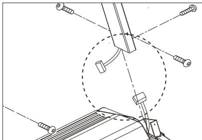
Зафиксируйте левую и правую стойки к основной части, используя болты №2 (по 3 в каждую стойку) и шестигранником №6.
