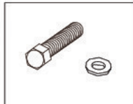
Ⓢ5: Болт М8-100 - 2 шт. Шляпки для болтов М8-2 шт.
