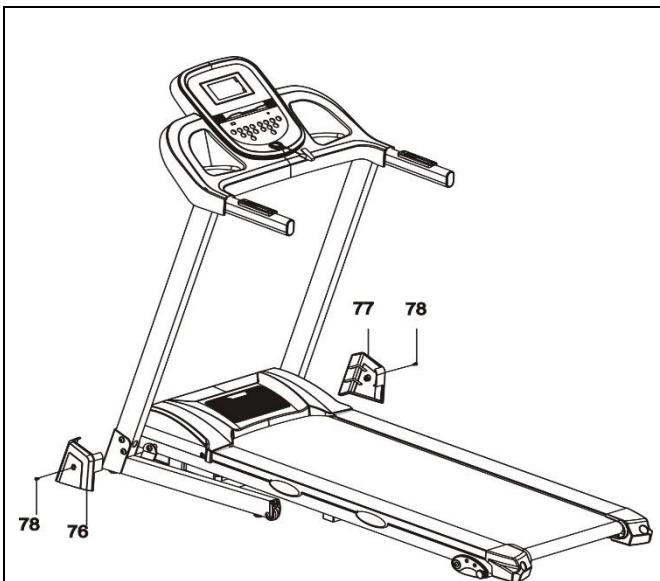
1. Используйте отвертку (11), чтобы установить левый кожух платформы (76) на платформу с помощью одного M4x10 (78), как показано на рисунке. Повторите процедуру для правого кожуха платформы (77).
