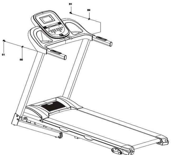
1. Используйте ключ на 5 мм(12) для установки консоли, левой и правой направляющих с помощью 2 болтов M8\*15(61) и 2 шайб M8(69). Обратите внимание на подключение кабеля, неверное подключение может привести к повреждению соединительного разъема.
