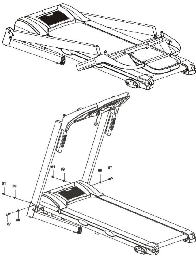
1. Поднимите направляющие и консоль. Установите направляющие с помощью 2 винтов M10\*40(57), 2 шайб M10(68), 2 винтов M8\*15(61) и 2 шайб M8(69), а также ключа (13). Обратите внимание на подключение кабеля, неверное подключение может привести к повреждению соединительного разъема.
