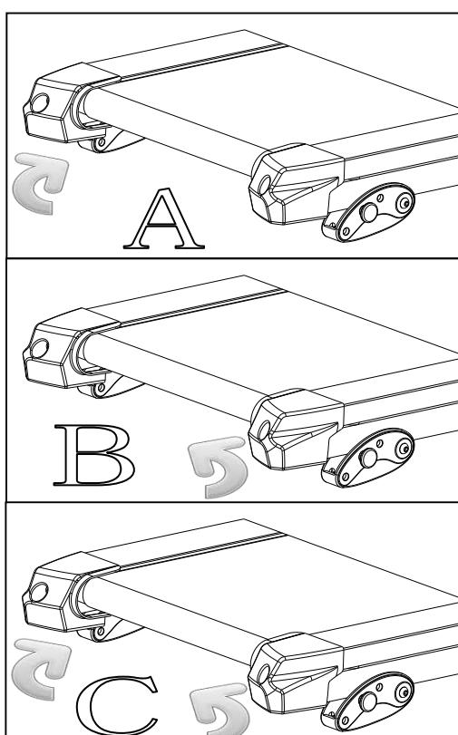
Если полотно имеет тенденцию сдвигаться влево, поверните регулировочный винт полотна слева по часовой стрелке на 1/4 оборота. Если смещение полотна влево сохраняется, поверните регулировочный винт полотна справа против часовой стрелки на 1/4 оборота, как показано на рисунке В.
