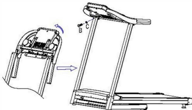
После того, как все винты будут вкручены, с помощью инструмента затяните установленные винты и вставьте ключ в предохранитель.
