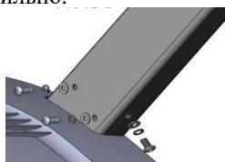
**Шаг 2:** Установите на стойки консоль тренажёра, закрепите её при помощи двух винтов M10\*20 ① и двух шайб ⑤.
