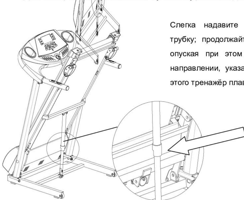
Слегка надавите на предохранительную трубку; продолжайте нажимать на трубку, опуская при этом беговую платформу в направлении, указанном стрелками. После этого тренажёр плавно опустится вниз.
