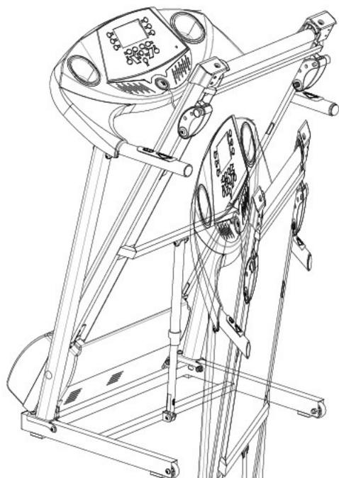
Поднимите беговую платформу к верхней части тренажёра и надавливайте на неё, прилагая усилия до тех пор, пока не услышите щелчок, который показывает, что предохранительный кожух защёлкнулся на пневматическом цилиндре.
