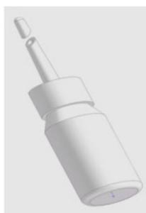
С. Залейте силиконовое масло (не более 90 мл, в противном случае резервуар переполнится), а затем закройте крышку резервуара.
