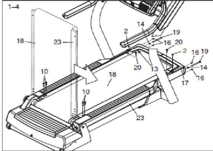
2. Открутите четыре винта с задней части беговой платформы (10) и два винта с передней части платформы (20). (Примечание: Будьте осторожны, чтобы не повредить фенольное покрытие беговой платформы [23].)
