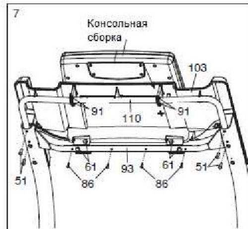
8. Затяните два винта  $\#8 \times 3/4"$  (86) в стойку (93) и основание консоли (109). **Не затягивайте винты слишком сильно.**
