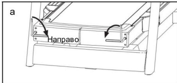
b. **Если беговое полотно сместилось влево:** выньте ключ и отсоедините сетевой кабель. При помощи шестигранного ключа на 7/32 дюйма поверните регулировочные винты в указанных направлениях, на 1/4 оборота каждый. Будьте осторожны, не перетяните беговое полотно. Затем подключите шнур питания, вставьте ключ и пройдите по беговой дорожке в течение нескольких минут. Повторите ту же процедуру, пока беговое полотно не окажется по центру.
