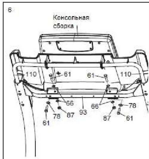
7. Установите четыре винта  $5/16" \times 1"$  (51) в соответствующие разъёмы на стойке тренажера (93) и консольной сборки (110); **Установите все четыре винта, а затем затяните их.**
