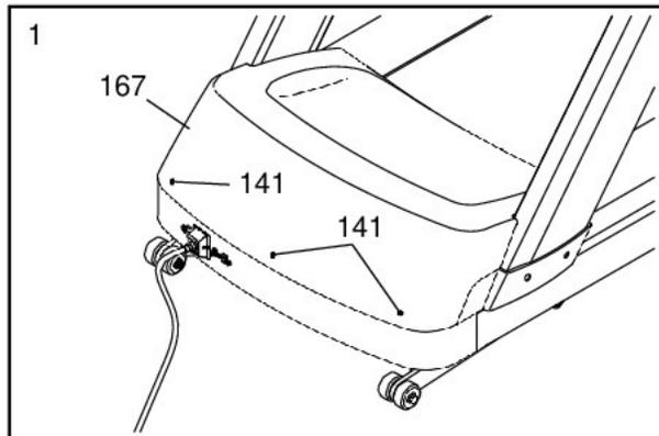
2. Используя портативный пылесос, очистите область под кожухом (не показано). **Постарайтесь не дотрагиваться до каких-либо деталей.** Затем проверьте приводной ремень (160) на наличие износа и трещин. Если необходимо заменить приводной ремень, см. заднюю обложку данного руководства.
