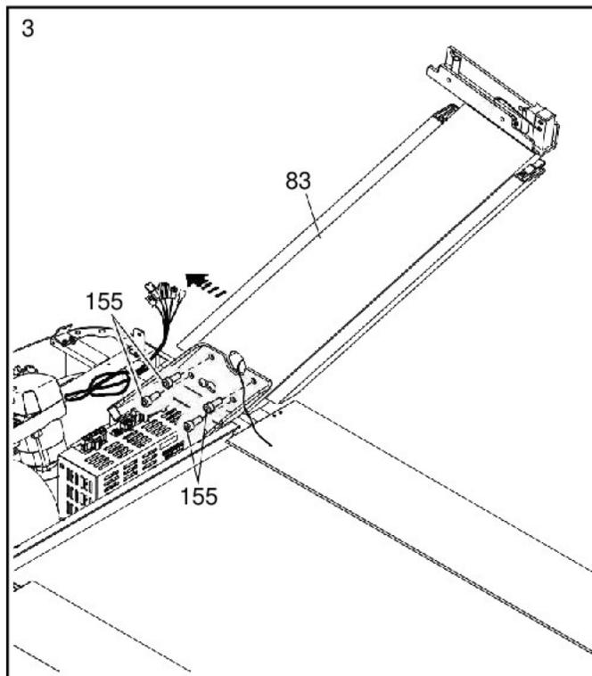
4. Надёжно закрепите нижний конец шнура (C) вокруг проводов (D). Затем вставьте кабель в нижний конец правой стойки (83), потянув за шнур вверх через правую стойку.
