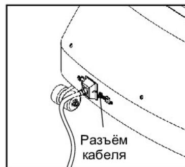
К беговой дорожке также можно подключить спутниковый приемник, видеомагнитофон или DVD-плеер. Подключите кабель CATV от коаксиального выхода вашего оборудования (обычно обозначенного TV OUT или RF OUT) к разъему кабеля на передней панели беговой дорожки.
