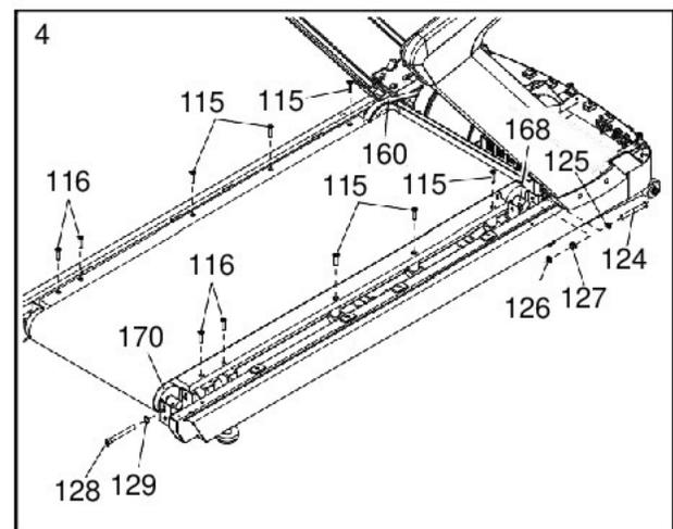
Затем снимите приводной ремень (160) с приводного ролика (168). Далее открутите два винта M12 x 110мм (128) и снимите стопорные шайбы M12 (129) с каждой стороны опорного ролика (170) (показана только одна сторона).
