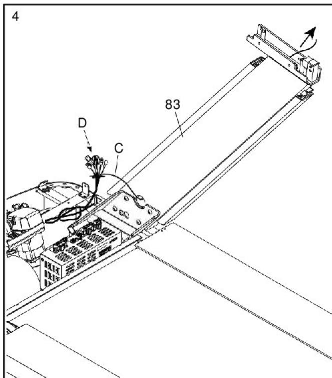
5. С помощью второго человека удерживайте поручень в сборе (E) между вертикальными стойками (82, 83). Протяните провода (D) с правой стойки вверх через указанное отверстие поручня.
