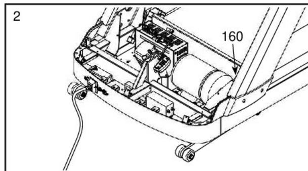
3. Подключите сетевой кабель и вставьте ключ в консоль. Нажмите на кнопку Quick Start (Пуск). **Во избежание травм держите руки и вашу одежду подальше от движущихся деталей тренажёра.** Во время движения бегового полотна проверьте беговую дорожку на необычные шумы или запахи. Если в ходе проверки работоспособности тренажёра возникли какие-либо проблемы, обратитесь в сервисный центр (см. заднюю обложку руководства).
