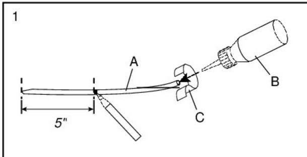
2. Вставьте край трубки под середину бегового полотна, как это показано на рисунке (166). Далее сожмите силиконовый флакон, вытягивая трубку из-под движущейся ленты, пока не увидите метку на трубке. Затем полностью выньте трубку из-под ленты. **То же самое повторите с другой стороны бегового полотна.**
