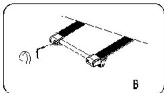
Если ремень отнесло влево, поверните левый регулировочный болт 1/4 оборота по часовой стрелке, а затем запустите дорожку, чтобы выполнить центрирование ленты. (рис. В)
