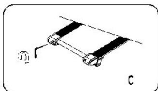
Своевременно корректируйте плотность натяжения полотна, т.к. после определенного периода времени натяжение ослабевает. Поверните левый и правый регулировочные болты на 1/4 оборота по часовой стрелке, а затем вновь запустите дорожку, отрегулируйте натяжение. (рис. С)
