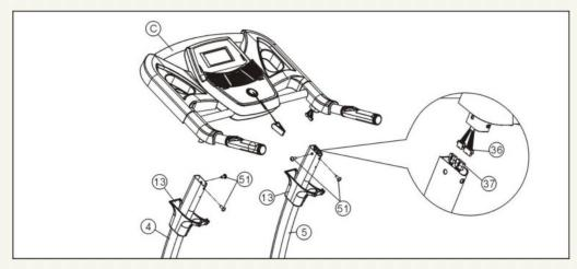
Наденьте кожух (13) на левую и правую вертикальные стойки (4 и 5). Соедините кабель А (36) и кабель В (37). Затем закрепите раму приборной панели (С) на правой и левой вертикальных опорах (4 и 5) с помощью болта с шестигранной головкой М8х15мм (51).
