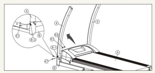
Поднимите левую вертикальную опору (4) и вставьте винт M8x50мм (47) через деталь (B-1) и основную раму (B), как показано на картинке. Затем закрепите основную раму (B) шайбой  $\psi 8$  (61) и нейлоновой гайкой M8 (63).
