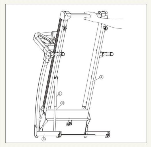
Поднимите вертикально раму ходовой части (А) и установите цилиндр (31), как показано на картинке.
