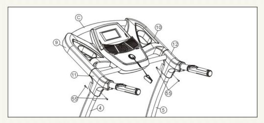
Соедините кожух (13) с левым декоративным кожухом (11) и правым декоративным кожухом (12), закрепите винтом с круглой головкой М4х20мм (55). Затем затяните винты на раме приборной панели (С) и вертикальных стойках (4&5). Затяните винты на раме приборной панели (С) и правой и левой стойках (9&10)
