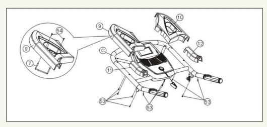
Прикрепите держатель для бутылки с водой (7) на левую стойку (9) и зафиксируйте винтом с полукруглой головкой М4х 10мм (54). Прикрепите левый декоративный кожух (11) и левую стойку (9) к раме приборной панели (С), закрепите винтом М4х 16мм. Затем прикрепите правый декоративный кожух (12) и правую стойку (10), таким же образом. **Не затягивайте винты.**
