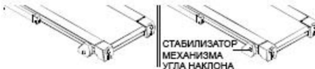
ПОЗИЦИЯ МАКСИМАЛЬНОГО УГЛА НАКЛОНА      ПОЗИЦИЯ МИНИМАЛЬНОГО УГЛА НАКЛОНА
