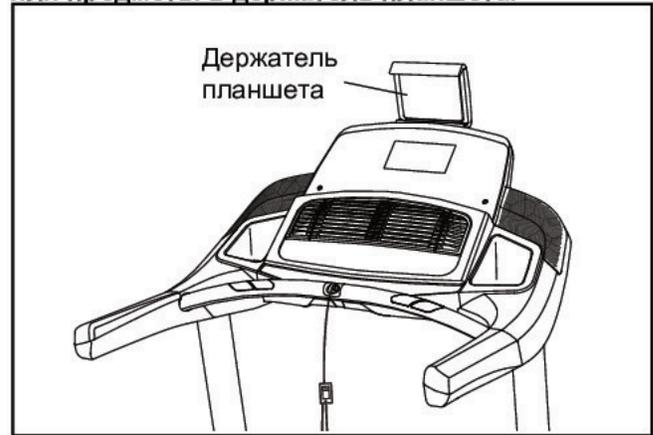
Вставьте планшет в держатель, установите нижнюю грань планшета в лоток. Затем потяните зажим на верхнюю часть планшета. **Убедитесь, что планшет надежно крепится в держателе планшета.** Измените последовательность этих действий, чтобы убрать планшет из держателя планшета.
