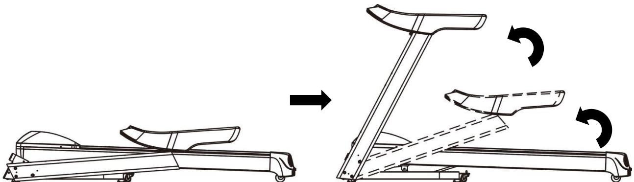
2. Установите стойки на основание и зафиксируйте их при помощи ключа под внутренний шестигранник 6#, винтов M10\*50 и винтов M8\*25 (не затягивайте винты до конца).
