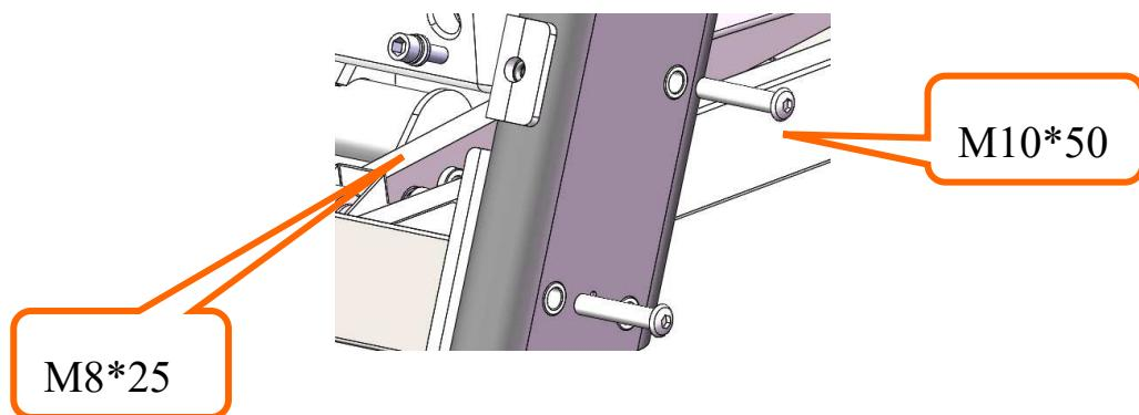
3. Установите консоль на стойки и зафиксируйте ее при помощи ключа под внутренний шестигранник 6# и винтов M8\*25 (не затягивайте винты до конца).
