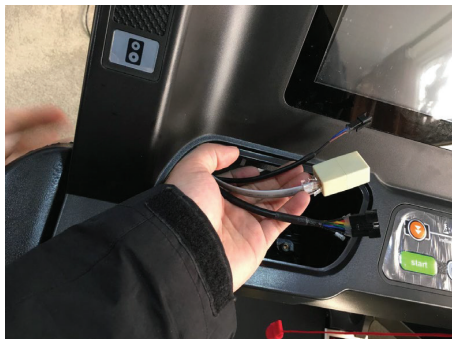
(Рис. 2) Кабель подсветки левого поручня и сигнальный кабель
