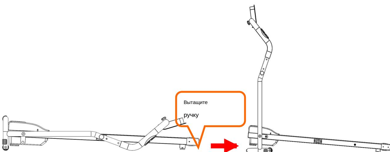
**2.** Придерживая основание, вставьте ручку регулировки в соответствующие отверстия основания корпуса и рамы, и затяните по часовой стрелке;
