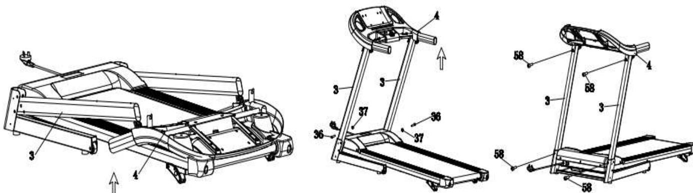
Шаг 3: Как показано на рисунках ниже: закрепите консоль (№40) на подставке (№4) с помощью крестообразных винтов ST4.2 \* 19 (№44). После этого соедините провода А и В и поместите ключ безопасности (№18) на желтую зону с передней стороны консоли.
