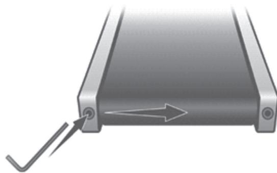
Для выполнения такой регулировки используется ключ для внутреннего шестигранника [идет в комплекте]. Установите скорость полотна 12 км/час. Помните, процесс регулировки инерционен. Поэтому после каждого регулировочного действия необходимо выждать до 1 мин. что бы убедиться в том, что беговое полотно смещается в нужную сторону на необходимую величину.
