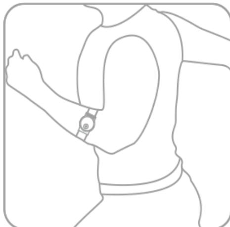
Браслет следует носить непосредственно на коже пользователя в верхней части предплечья. Датчик должен быть на внутренней стороне или верхней части предплечья. Его следует надевать достаточно плотно, чтобы он не двигался на руке, и не слишком туго, иначе он будет ограничивать кровообращение в руке и вызывать неправильную ЧСС.
