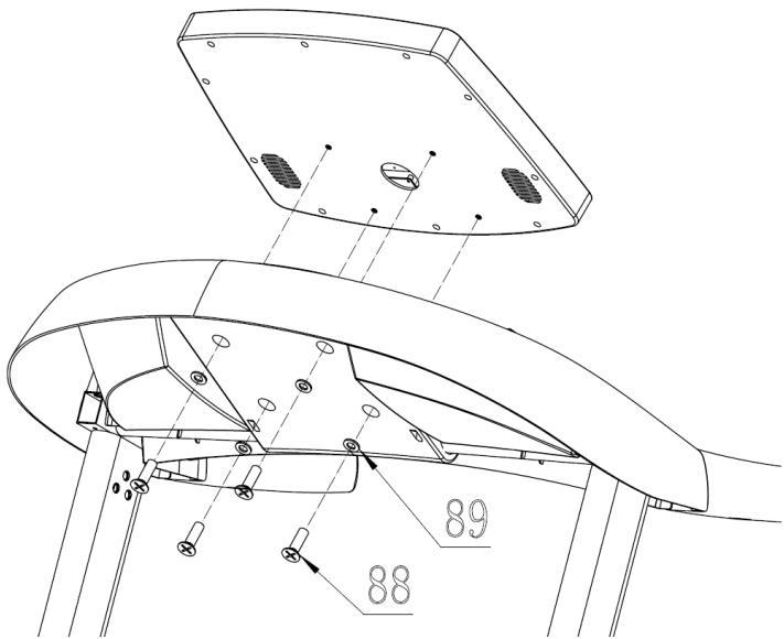
Зафиксируйте защитный кожух на стойках, используйте болты M5\*15 (88) и шайбы Ф6.
