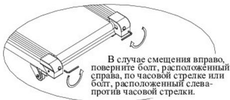
В случае смещения влево, поверните болт, расположенный слева, по часовой стрелке или болт, расположенный справа - против часовой стрелки.
