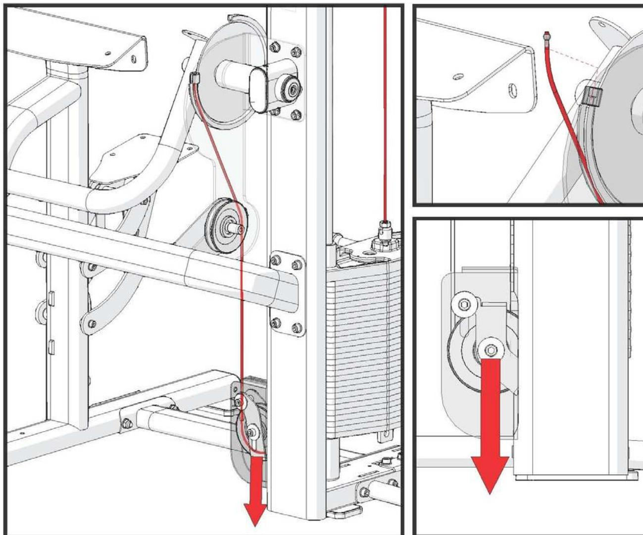
*Натяжение кабеля регулируется фиксатором.*
