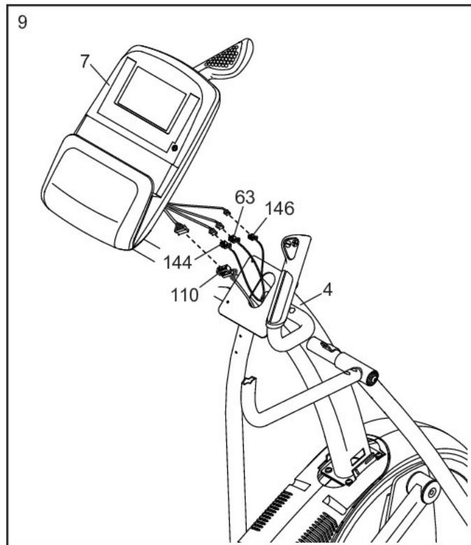
10. **Совет: Не пережмите провода.** Прикрепите консоль (7) к стойке (4) с помощью четырех винтов M4 x 16мм (101).
