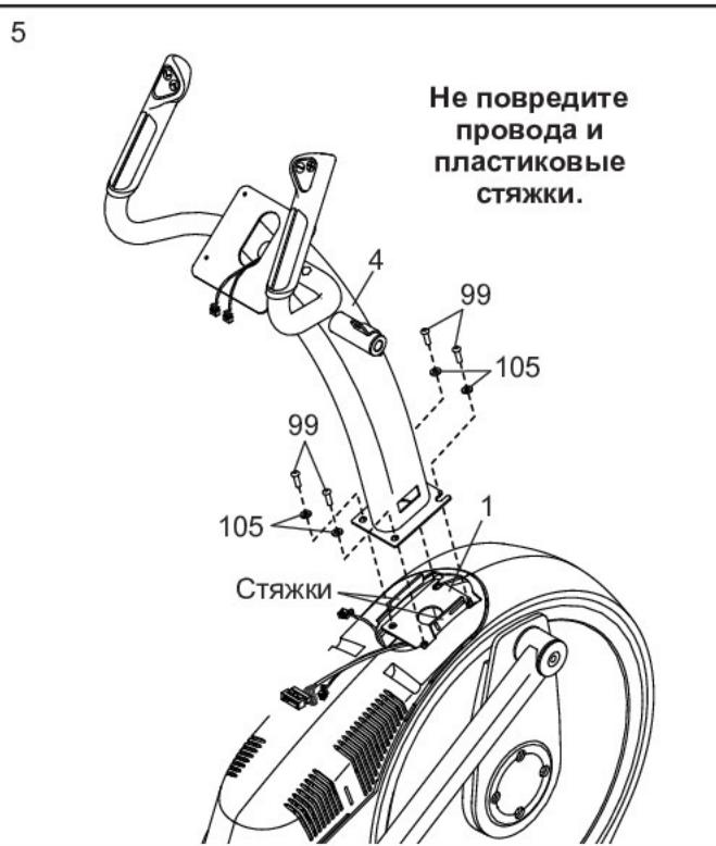
6. См. врезку на рисунке. Расположите шнурок кабеля в нижней части стойки (4). Подцепите через верхний конец стойки шнурок (110) и удлинитель вентилятора (146). Затем, протяните стяжку с верхним концом шнурка и удлинителем вентилятора через стойку.
