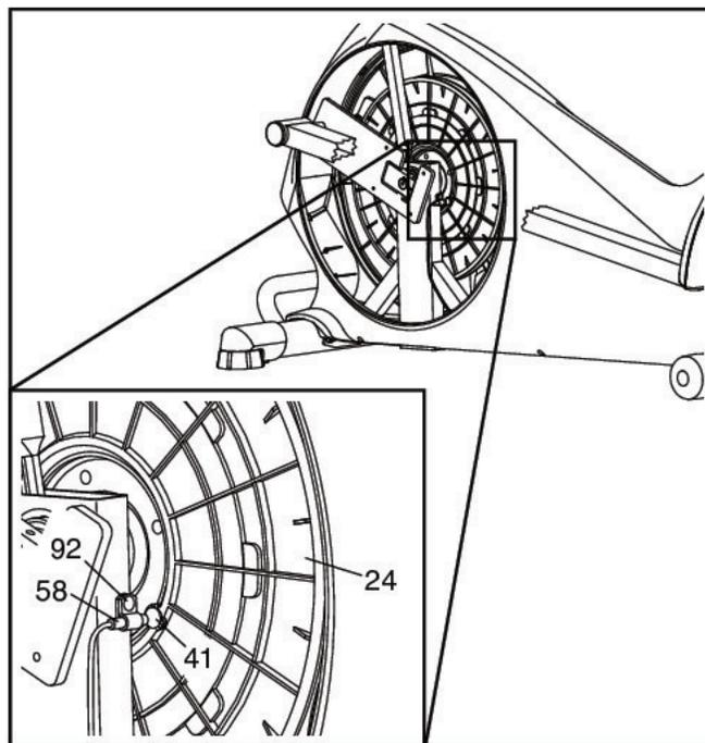
Далее, поверните блок (24), чтобы магнит (41) совместился с герконом (58). Сдвиньте геркон немного в сторону магнита или от него, затем затяните винт М4 x 16 (92).
