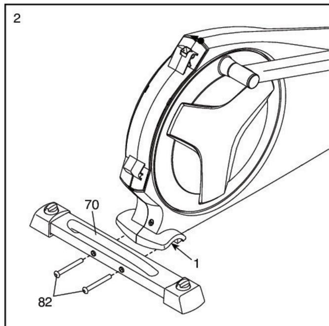
3. Пока помощник поднимает переднюю часть рамы (1), двумя винтами M10 x 95 (82) прикрутите к раме передний стабилизатор (73).
