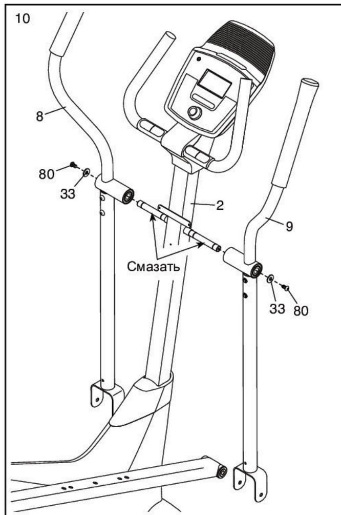
11. Нанесите немного смазки на болт с буртом (31).
