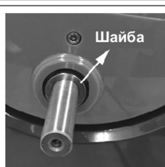
а. См. рисунок слева. Аккуратно снимите полиэтилен с обеих Осей.
