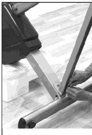
с. Установите еще 1 **Болт с головкой под шестигранник (97)**, 1 **Стопорную шайбу (74)**, 1 **Шайбу (76)** снизу **Перекладины (34)**. **ПРИМЕЧАНИЕ: Не затягивайте болт до конца.**
