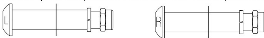
#63 Шарнир. винт от л. педали t 1/2" 1шт #64 Шарнир. винт от п. педали 1/2" 1шт #43 Ф16хФ26хδ0.3 1шт #43 Ф16хФ26хδ0.3 1шт #65 Пружинная шайба 1/2"хδ2.0 1шт #65 Пружинная шайба 1/2"хδ2.0 1шт #66 Л. нейлонная гайка 1/2" 1шт #67 П. нейлонная гайка 1/2" 1шт
