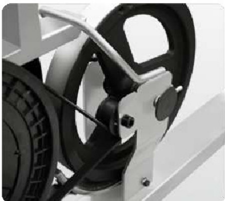
Элементы магнитной приводной системы magicFLOW™
