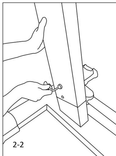
2-2 Зафиксируйте стойку при помощи 8 винтов.
