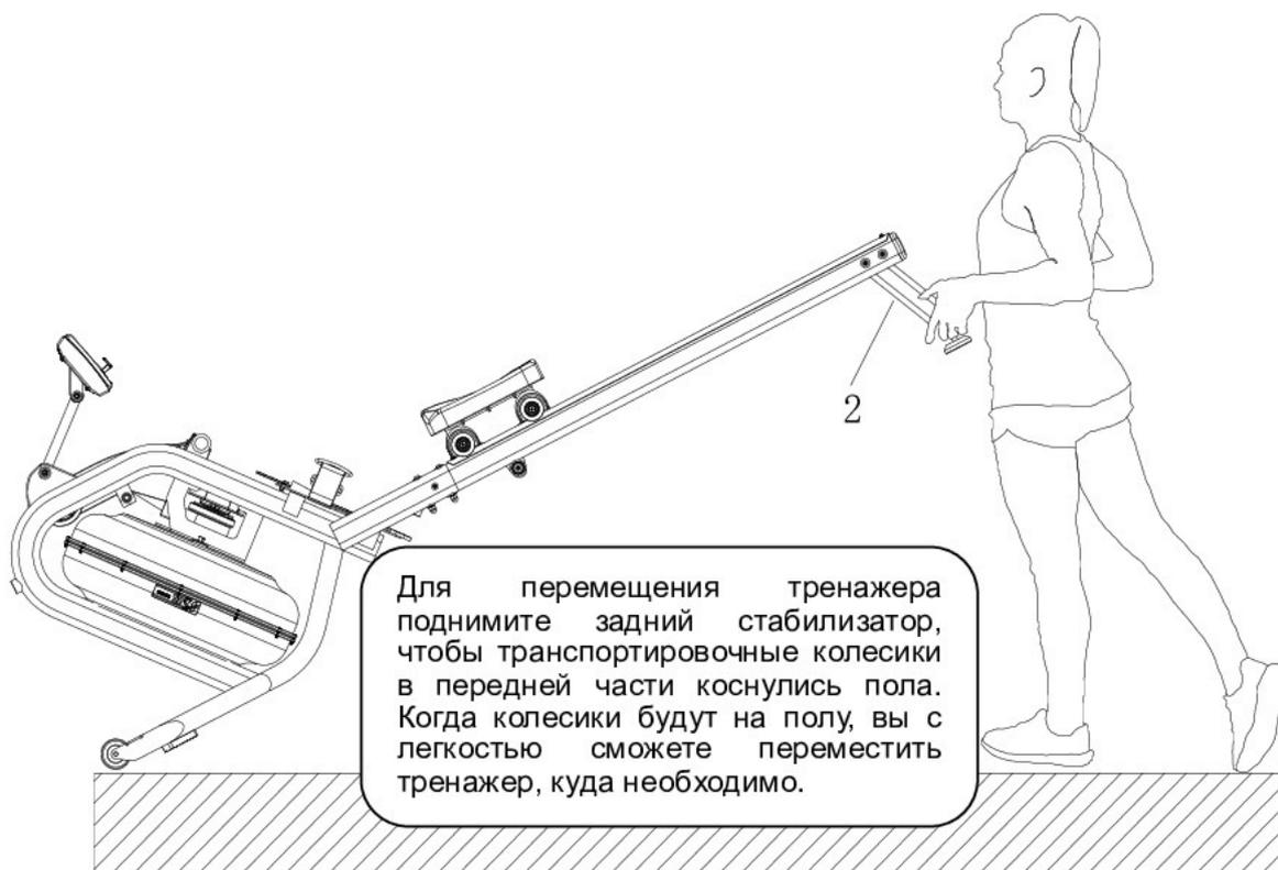
Для перемещения тренажера поднимите задний стабилизатор, чтобы транспортировочные колесики в передней части коснулись пола. Когда колесики будут на полу, вы с легкостью сможете переместить тренажер, куда необходимо.
