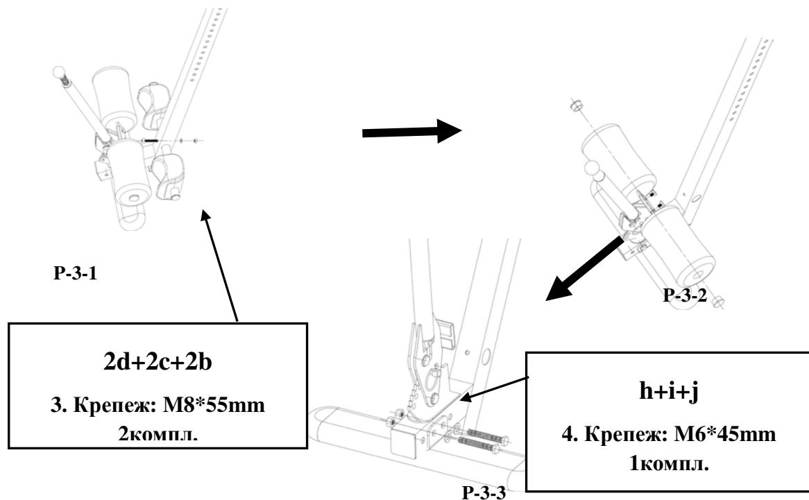
**Шаг 4:** Вставьте собранный регулировочный кронштейн в опорную раму:
