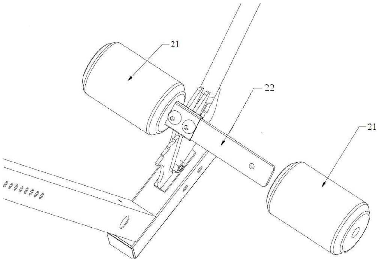
Соедините круглый стержень #22 и скобу держателя ног #15 с помощью винтов #29 и гаек #13.
