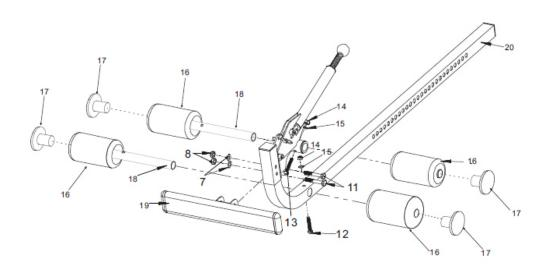
Шаг 5 Сборка регулировочной рукоятки.
