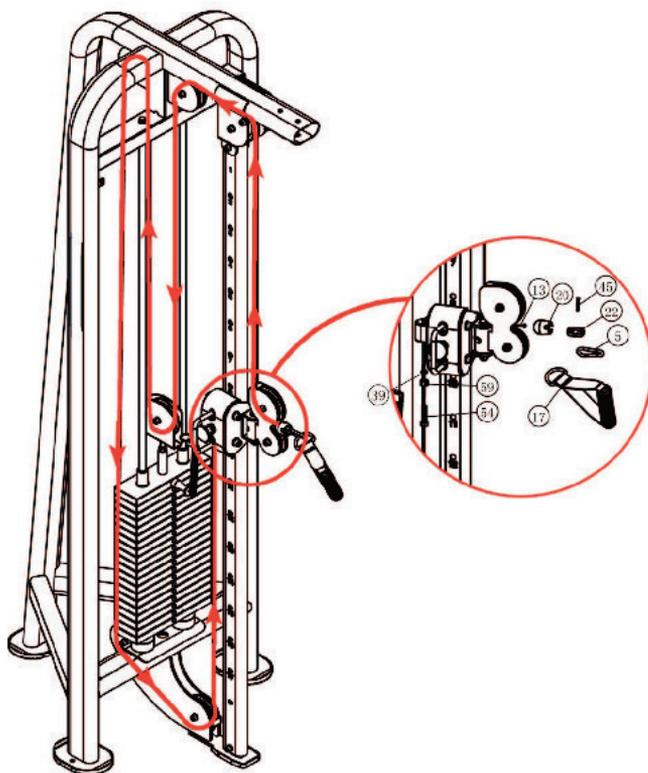
1. Как показано выше, пропустите трос через фиксирующую втулку (# 20) и кронштейн (# 22). Затем вставьте кронштейн в крепежную втулку и затяните винтом (# 45).
