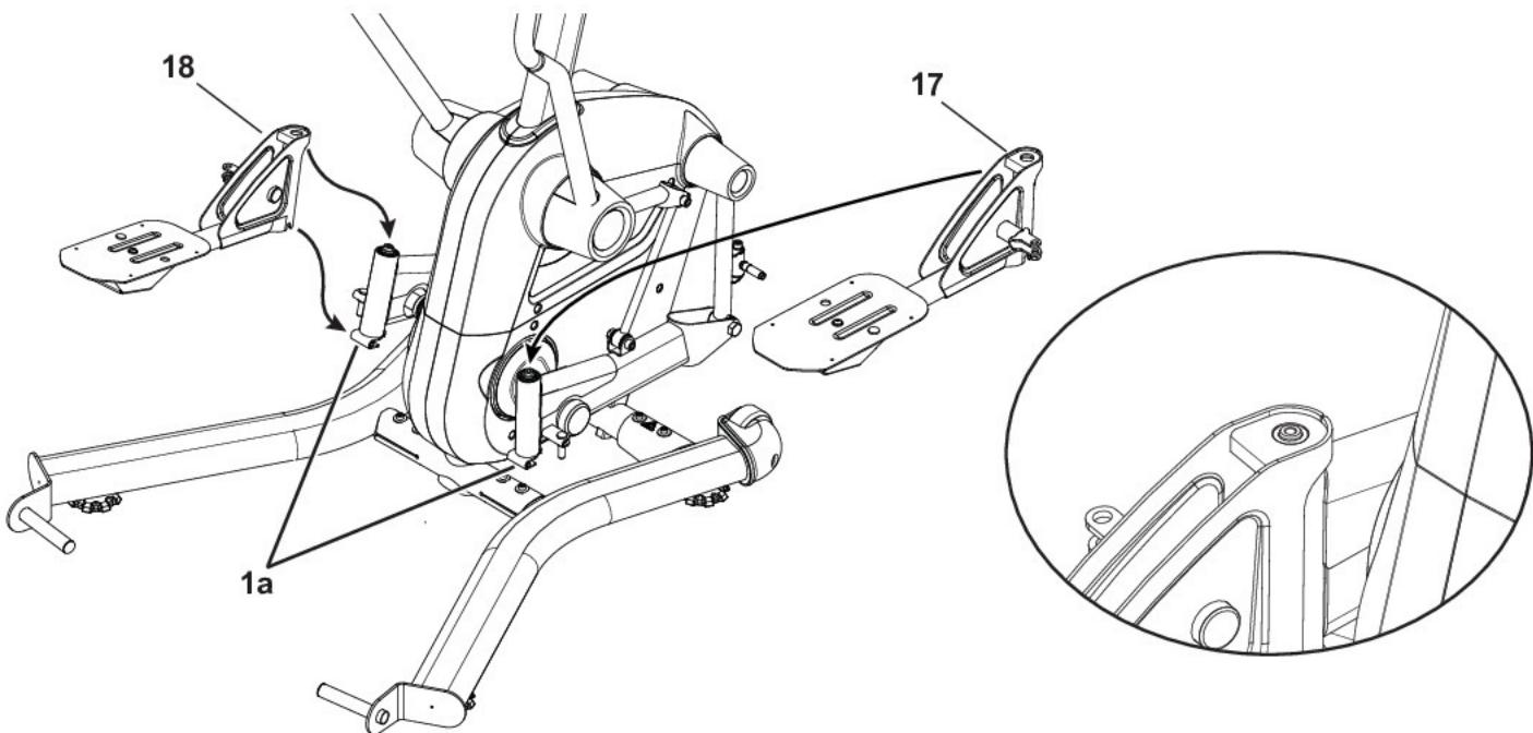
**3.** ПОСЛЕ установки рычага педали установите большую шайбу (M, с большим отверстием) сверху на отверстие рычага педали. Затем установите широкую шайбу (J, малое отверстие) сверху на большую шайбу (M).
