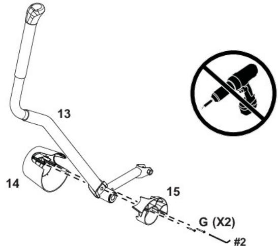
2. Соединение рукоятки (9) должно быть наклонено вперед. Наденьте волнистую шайбу (I) на шарнирный стержень. Выровняйте ручку рукоятки с шарнирным стержнем и прикрепите нижнюю ручку рукоятки к соединению рукоятки. Наденьте ручку рукоятки на шарнирный стержень до конца и установите соответствующие крепежные изделия.
