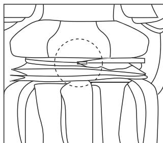
**Шаг 3:** Подключите провод прогрева спинки и провод вибрации сиденья.
