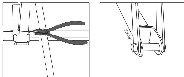
**Шаг 6:** Поднимите спинку кресла и затем опустите ее вниз, чтобы головки болтов спинки попали в пазы сиденья. Надежно зафиксируйте головки болтов в пазах сиденья.
