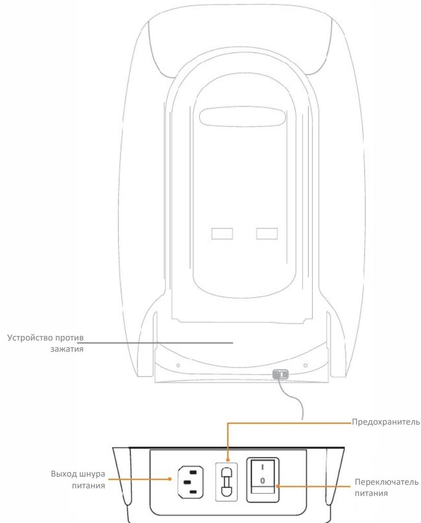
Устройство против зажатия: массажное кресло автоматически прекратит отклонение при определении любого постороннего предмета (например, руки или ребенка). Спинка продолжит отклоняться при удалении постороннего предмета.
