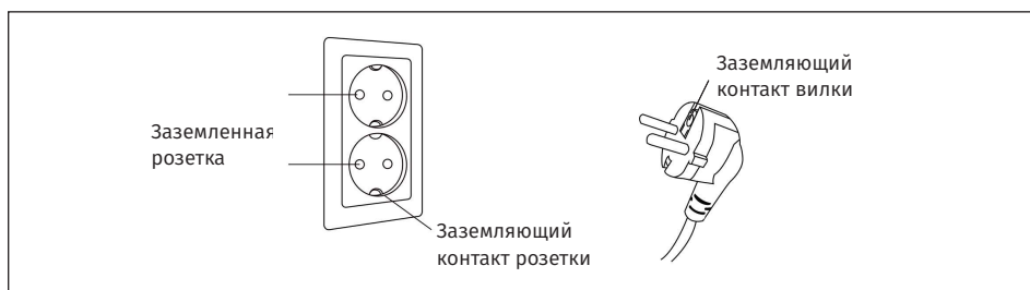
Рисунок 10 – Правильное заземление массажного кресла
