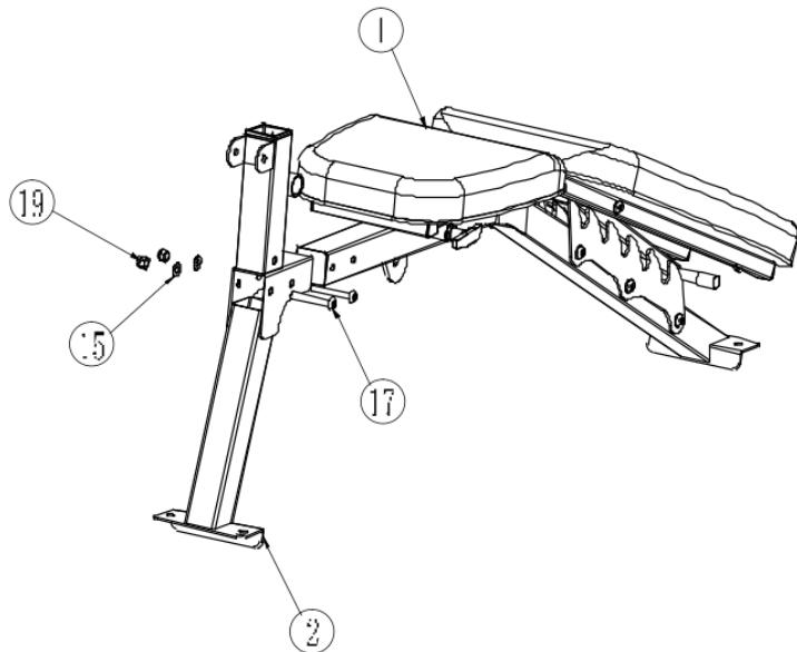
1. Установите переднюю стойку (2) на основную раму (1), а затем используйте болты M10\*65 (17), шайбу (15), гайку (19), ключ (28) и шестигранный ключ (30), чтобы закрепить детали.
