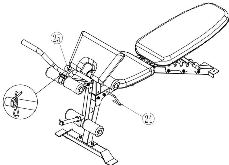
1. Вставьте стержень с крючками (24) в переднюю опору (2) и опору для ног (5), затем установите ограничительное кольцо Ø10 (25), чтобы закрепить детали.
