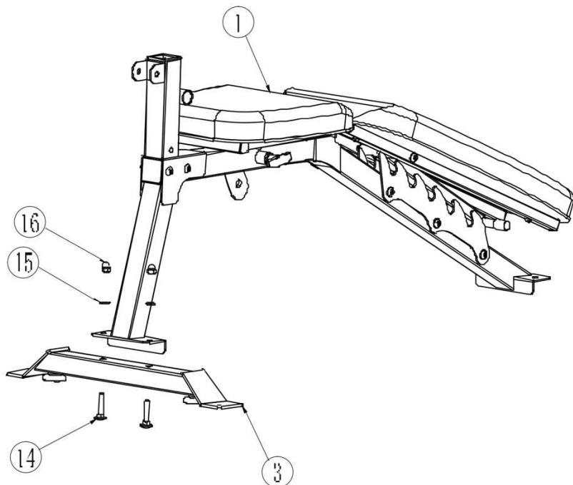
1. Вставьте винт (14) в передний стабилизатор основной рамы (1), затем с помощью ключа (28), плоской шайбы (15) и гайки (16) зафиксируйте детали.
