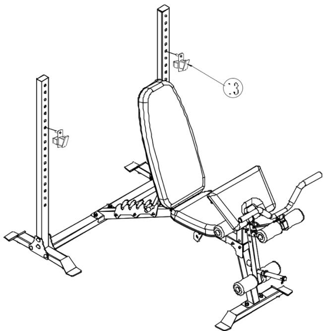
Крепления для гантелей (13), как показано на рисунке, можно вставлять в разные отверстия, чтобы регулировать высоту штанги в соответствии с различными размерами. Сборка завершена.
