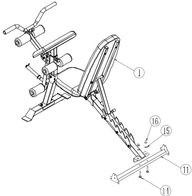
Установите задний стабилизатор (11) на основную раму и используйте два болта №14 М10x50, две плоские шайбы (15), две шестигранные гайки M10 (16), ключ с открытым концом № 15-13-17, чтобы зафиксировать детали.
