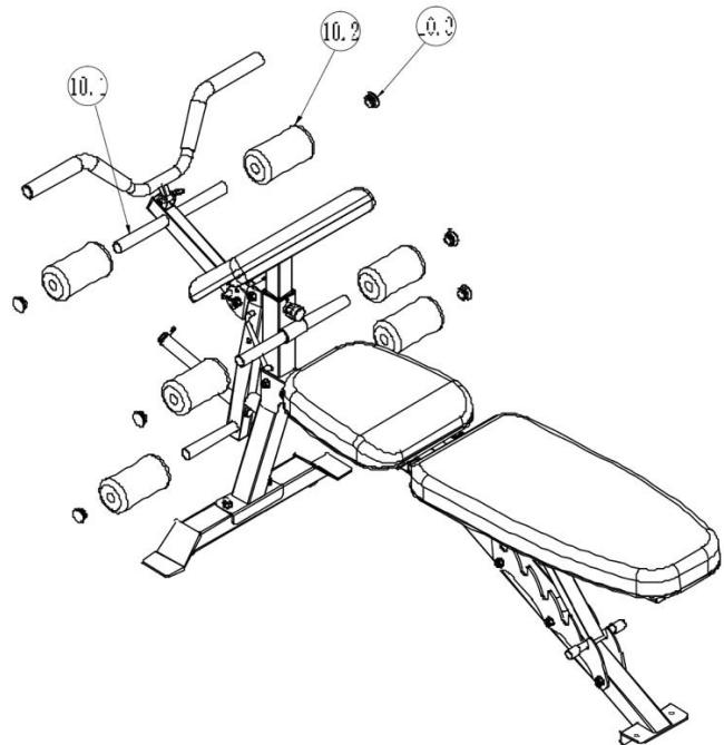
1. Установите 3 пары неопреновых роликов на переднюю опору (2), опору для ног (5) и переднюю стойку (6), а затем вставьте заглушки с обоих концов соответственно.
