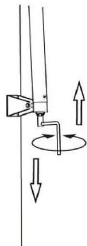
Ручку (R) можно снять или хранить, достав маленький болт (Z1) в конце механизма регулировки (Z)
