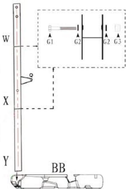
Зафиксируйте нижнюю секцию стойки Y в переднем отверстии на основании BB. Убедитесь, что скоба Q смотрит назад для осуществления следующего этапа сборки.
