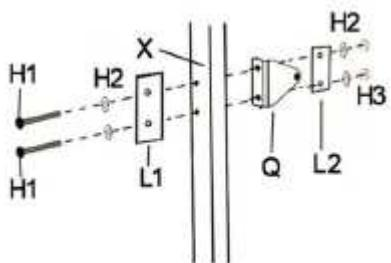
Закрепите скобу Q, пластину L1 и L2 на средней секции стойки X с помощью наборов болтов H1, H2, H3
