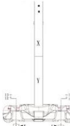
2. Зафиксируйте верхний конец подпорок U1, U2 на средней секции стойки X с помощью наборов болтов F1, F2, F3, F4, как показано на рисунке
