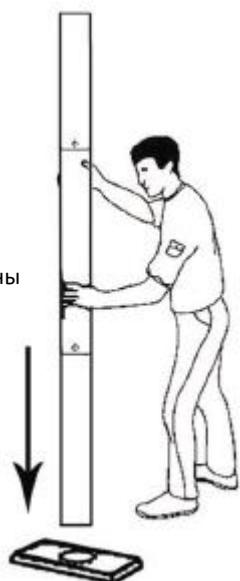
Зафиксируйте три секции стойки с помощью наборов болтов G1, G2, G3
