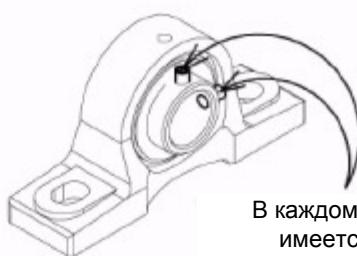
В каждом опорном подшипнике имеется по два маленьких установочных винта (45).
