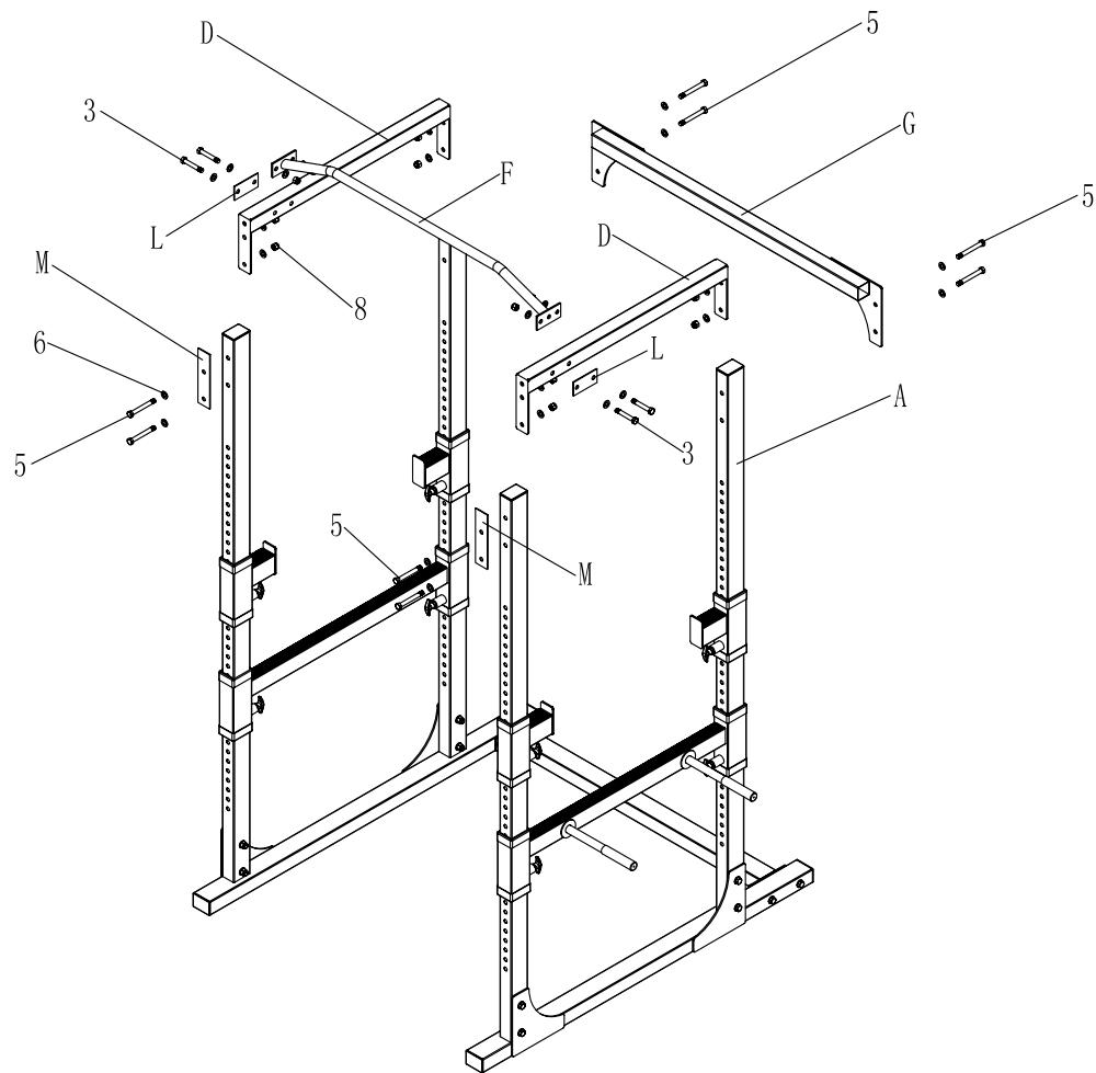
1. Прикрепите (D) к (A) с помощью (M) и болтов M12\*100 (5)+ шайб 12 (6) + контргаек M12 (8), прикрепите (G) к (A) и к (D) с помощью болтов M12\*100 (5) + шайб 12 (6) + контргаек M12 (8).
