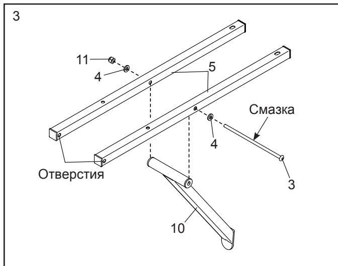
4. Нанесите небольшое количество смазки на Болт M10 x 202мм (3).
