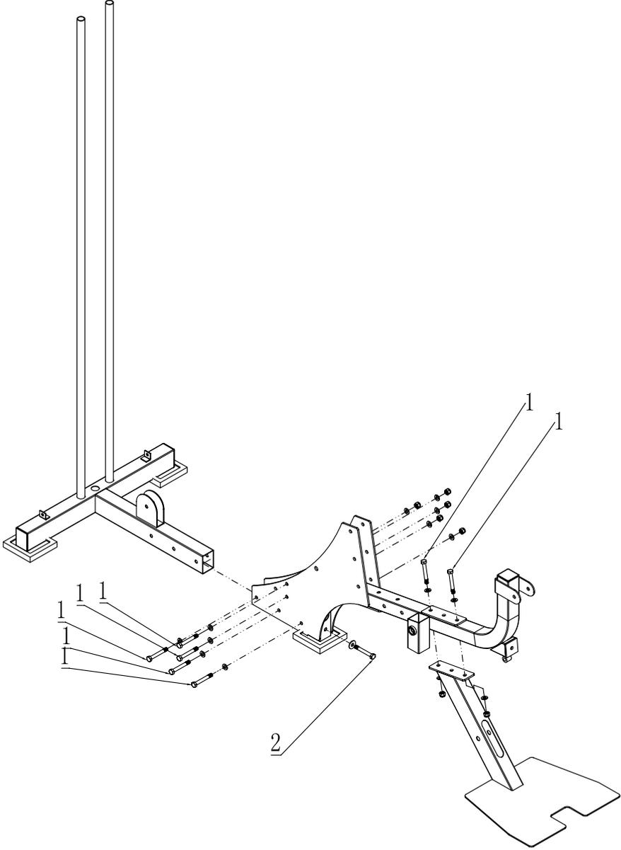
1 M10\*75 болт, гайка,
