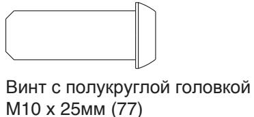
Винт с полукруглой головкой M10 x 25мм (77)
