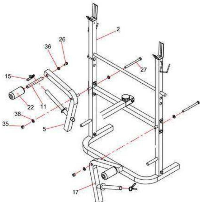
Зафиксируйте основы перил (правая) (5) & (левая) (17) на 2 стойках под штангу (2) болтом (27), шайбой (36) и гайкой (35), затем закрепите ось для валиков (11) опоры перил (правая) (5) & (левая) (17) с помощью болта (26) и плоской шайбы (36), установите валики из пенорезины (22) и пружинные защелки (15), как показано на рисунке.
