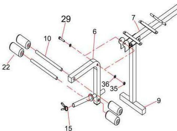
Прикрепите основание опоры для ног (6) у держателям на соединительной раме (7) с помощью болта (29), шайбы (36) и гайки (35). Вставьте опору для ног (10) в отверстие на основании (6), установите 4 валика из пенорезины (22) по обе стороны, затем закрепите пружинными защелками (15), как показано на рисунке.
