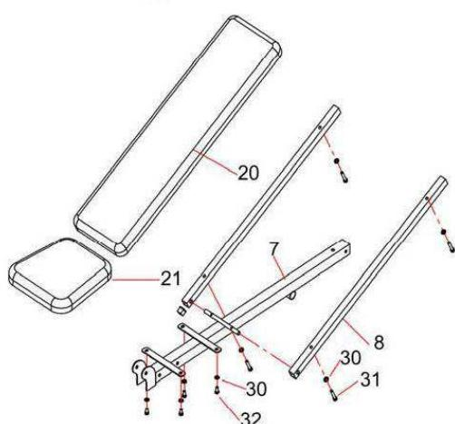
Зафиксируйте 2 держателя спинки (8) на оси соединительной рамы (7), затем прикрепите спинку (20) к двум держателям (8) с помощью болта (31) и шайбы (30). Зафиксируйте сиденье (21) на соединительной раме (7) болтом (32) и шайбой (30), как показано на рисунке.
