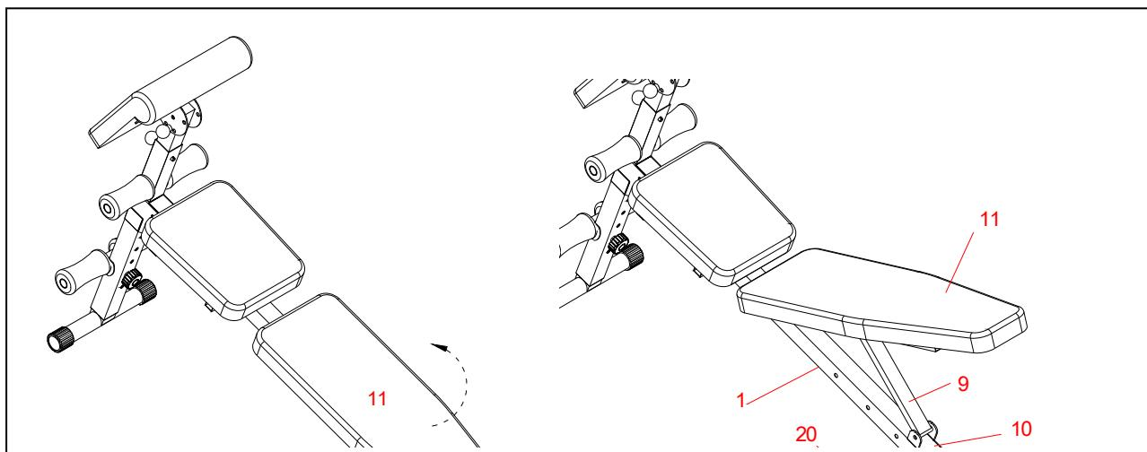
5. Силовая скамья DALLAS может складываться и удобно храниться, для этого следует немного выдвинуть станину (1) из U-образного кронштейна передней опорной стойки (2).
