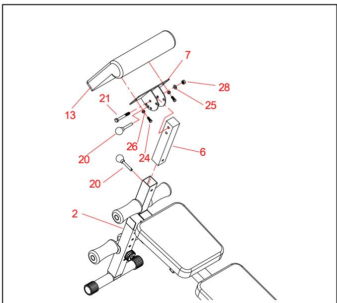
3. Прикрепить парту для бицепса (13) к соответствующей пластине (7) шестиугольным болтом (24) и плоской шайбой (25). Присоединить к пластине (7) регулирующуюся трубку (6) шестиугольным болтом (21), плоской шайбой (25) и стопорной гайкой с нейлоновой вставкой (28). Регулируйте углы наклона парты для бицепса с помощью штифта (20). Вставить регулирующуюся трубку (6) в переднюю опорную трубку (2) и зафиксировать в нужном положении, используя штифт (20)
