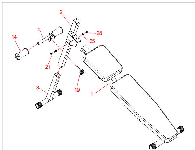
1. Вставить переднюю стабилизирующую опору (3) в переднюю опорную стойку (2). Присоединить соединительную ось опоры ног (4) к передней стабилизирующей опоре (3) и передней опорной стойке (2), зафиксировав их в нужном положении с помощью головки штифта (19). Прикрепить станину (1) к передней опорной стойке (2) при помощи шестиугольного болта (21), плоской шайбы (25) и стопорной гайки с нейлоновой вставкой (28).
