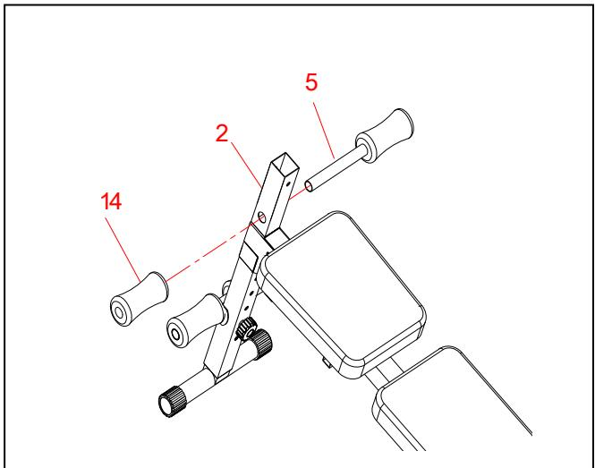
2. Присоединить соединительную ось верхней опоры ног (5) к передней опорной трубке (2) и зафиксировать поролоновым валиком (14).
